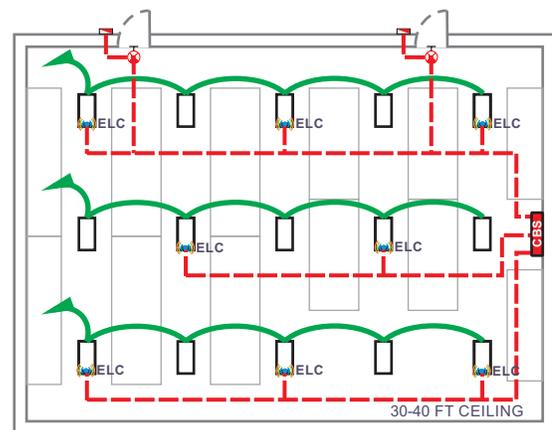
— EMERGENCY LIGHTING CIRCUIT: LOW VOLTAGE 24 VDC
